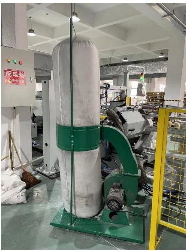
图 3-4 铝屑回收装置现状图
